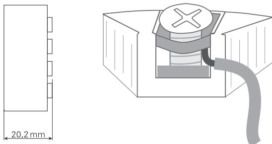
Провод монтируют между пластинами
